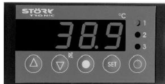
Der Regler wurde für Regelungen entwickelt, bei denen mehrere Ausgänge benötigt werden. Über eine Folientastatur mit 5 Tasten werden der Sollwert, Standby und alle Parameter der Regler eingestellt.
